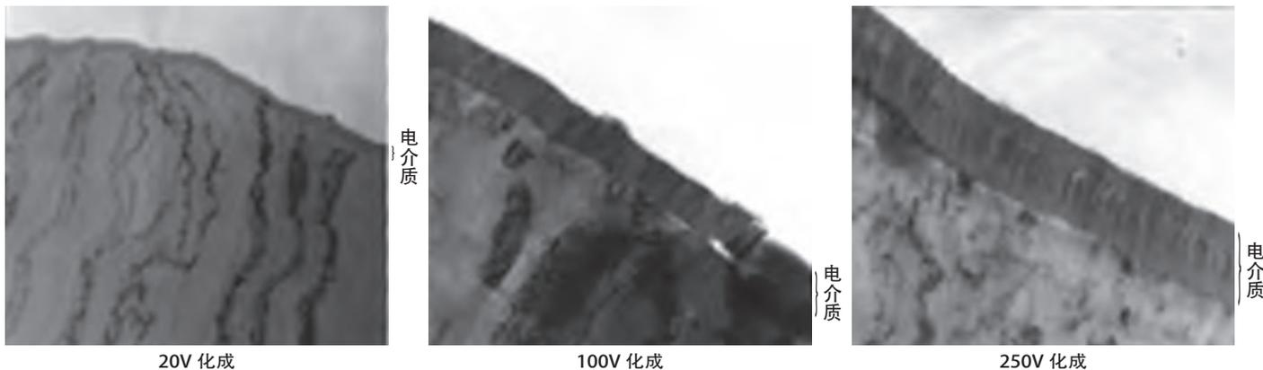
照片1-3 电介质（铝氧化膜）截面照片（纯铝箔表面上生成电介质）
